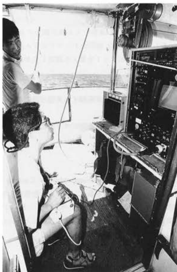
Fig.28 RTV-300のモニター部とコントローラー Monitor and controler of RTV-300
